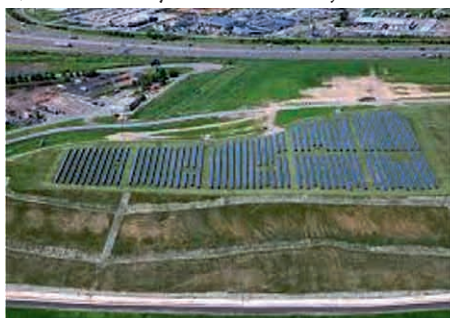
Rys. 5.2. Farma fotowoltaiczna na zrehabilitowanym składowisku odpadów komunalnych [www.watershedgeo.com]
