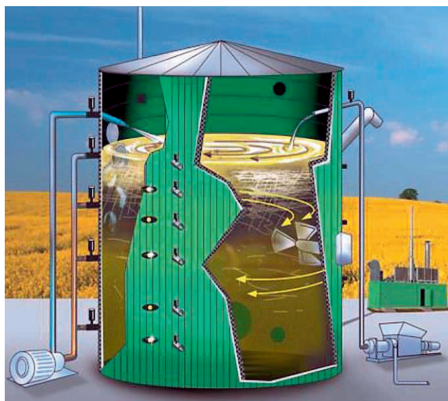
Rys. 2.3. Reaktor PRV i ATB Potsdam do fermentacji gnojowicy i buraków pastewnych [Vollmer-Heuer 2017]
