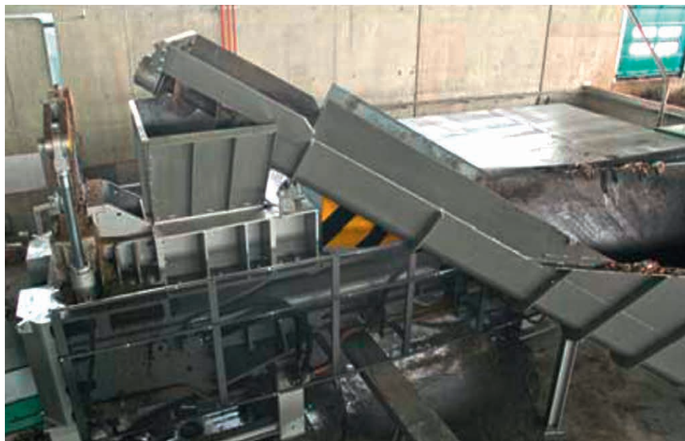
Rys. 2.10. Ekstruder firmy VMPRESS [za http://kmhsys.com/gallery/vm-press/ ]
