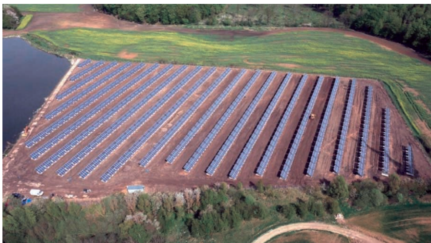
Rys. 5.3. Farma fotowoltaiczna na zrekultywowanym składowisku śmieci (wieś Kukinka, gmina Ustronie Morskie) [www.portalsamorzadowy.pl]
