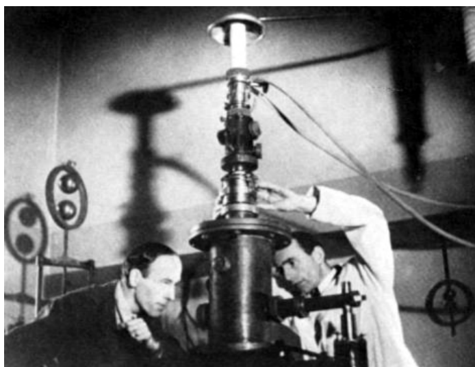
Rys. 2.1. Pierwszy transmisyjny mikroskop elektronowy z 1931 r.
