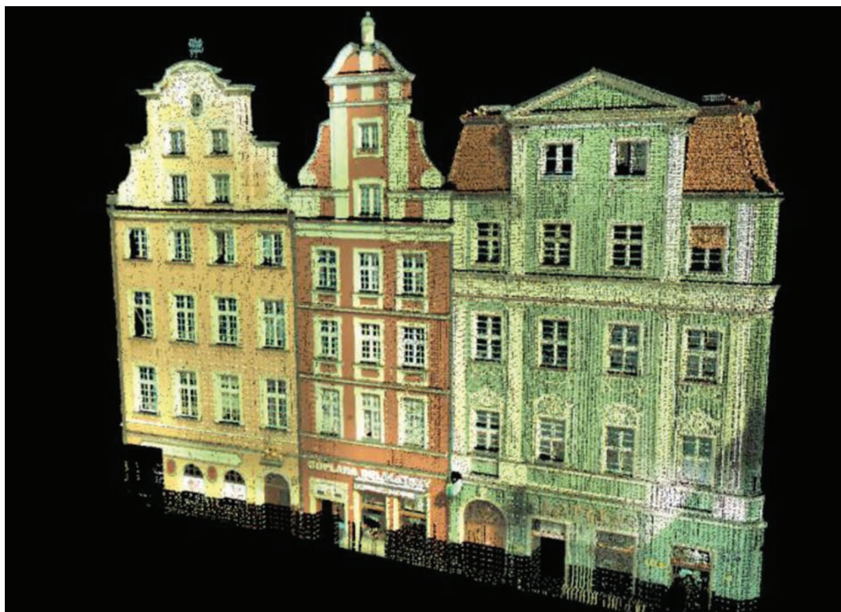
Il. 1. Wstępnie wyczyszczona chmura punktów w kolorach RGB pozyskanych ze skanera – Rynek 42–44, Wrocław (oprac. M. Stepnowska, [10, s. 80])
