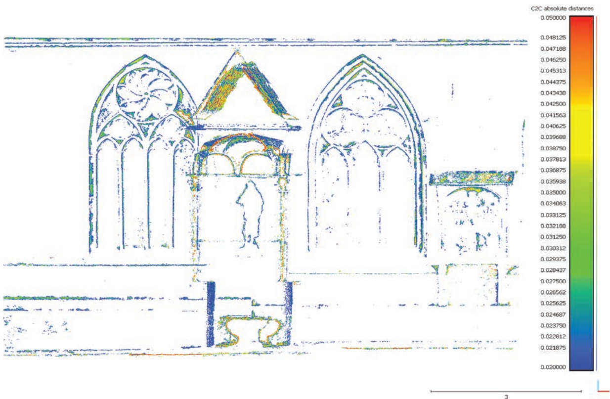
Il. 7. Rozkład różnic odległości dla porównywanych chmur punktów w przedziale wartości 2–5 cm (oprac. P. Szymański)
