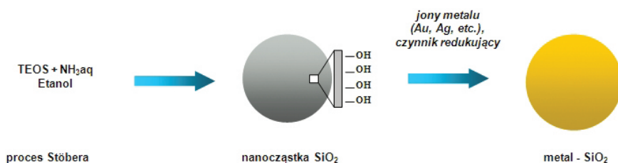
Rysunek 5. Schemat otrzymywania nanowarstwy metalicznej na rdzeniu krzemionkowym poprzez bezpośrednią redukcję jonów metalu
