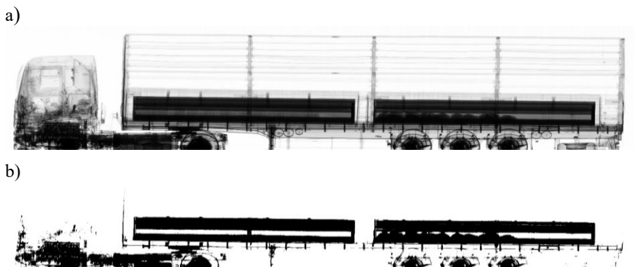
Rysunek 5. Widok samochodu prześwietlonego metodą RTG a) zdjęcie RTG, b) zdjęcie po binaryzacji.
