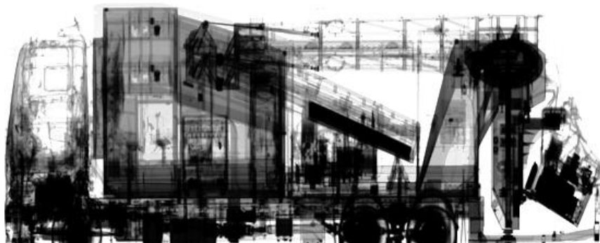
Rysunek 4. Obraz RTG prezentujący mobilne urządzenie RTG (Rapiscan MXR3040) wykonane urządzeniem wyposażonym w podwójną energię (Rapiscan G60)
