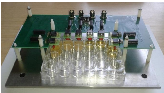
Rysunek 2.38. Multiplexer 8-kanalowy z czujnikami w uchwytach i płytką titracyjną.
