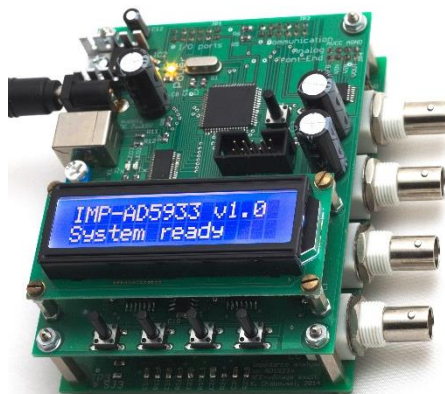
Rysunek 2.26. Prosty miernik impedancji z szerokim zakresem częstotliwości zbudowany w oparciu o układ scalony AD5933: a) schemat blokowy, b) widok ogólny.
