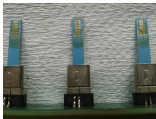
Rysunek 3.34. Biofilm P. aeruginosa na powierzchni czujników LTCC po 168 godzinach inkubacji.
