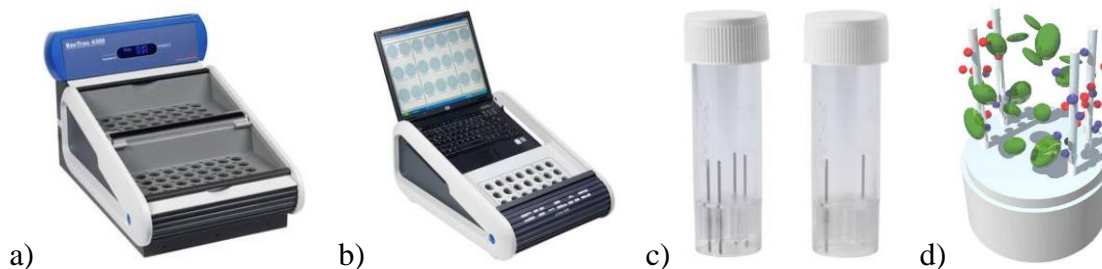
Rysunek 1.13. Urządzenia: a) BacTrac 4300 i b) BioTrac 4250, c) celki pomiarowe cztero i dwuelektrodowa oraz d) wizualizacja elementów biologicznych w celce [92].
