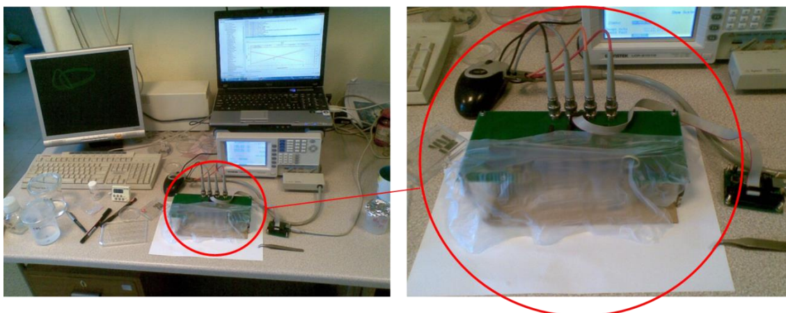
Rysunek 3.18. Stanowisko pomiarowe do monitorowania adsorpcji białek (lewy). Zbliżenie na multipleksjer przykryty parafilmem dla odizolowania od wpływu otoczenia (prawy).
