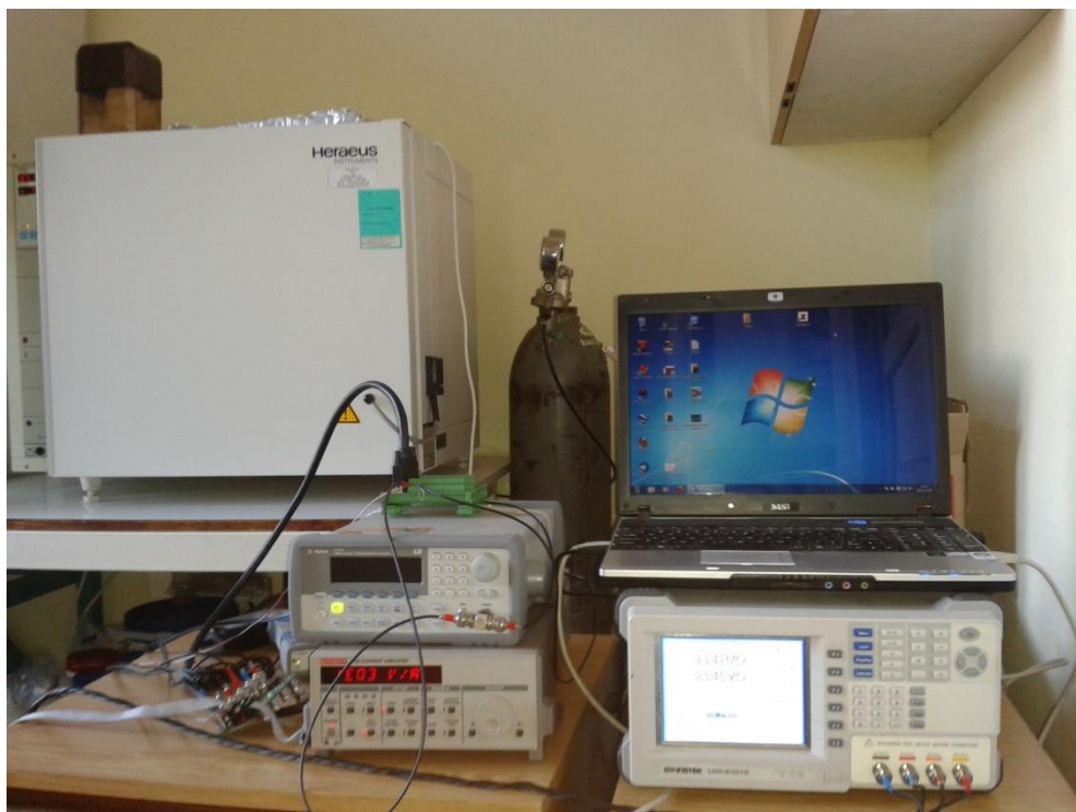
Rysunek 3.23. Stanowisko pomiarowe. Widoczny jest analizator impedancji, komputer z oprogramowaniem ImpeDancer oraz cieplarka.
