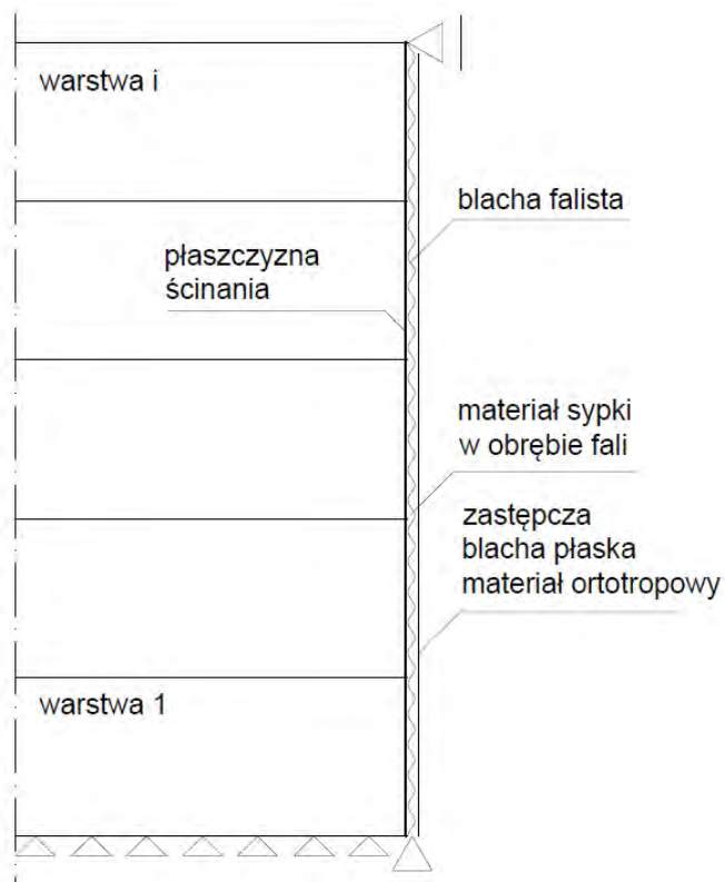
Rys. 5.2. Osiwosymetryczny model numeryczny uzębrowanego silosu wypełnionego ośrodkiem sypkim
