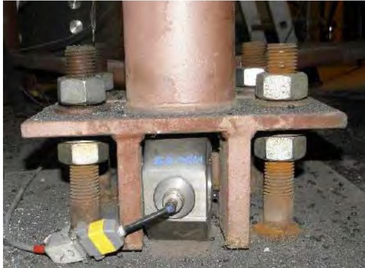
Rys. 4.6. Siłomierz do rejestracji sił pionowych pod jedną z podpór silosu
