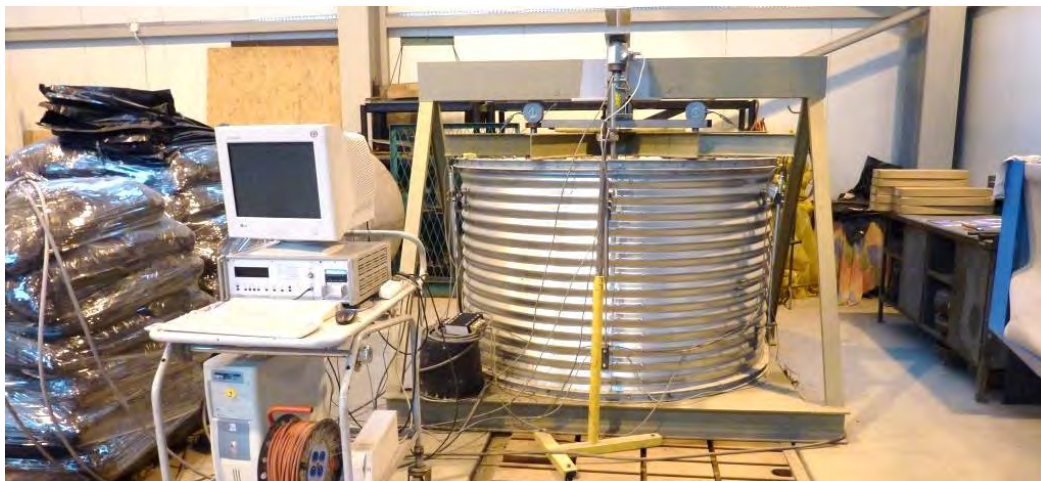
Rys. 4.8. Widok stanowiska badawczego z jednostkowym modelem płaszcza silosu
