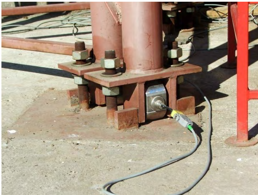
Rys. 2.24. Widok stanowiska badawczego Pawłowskiego – siłomierze do pomiaru siły w słupach [65]
