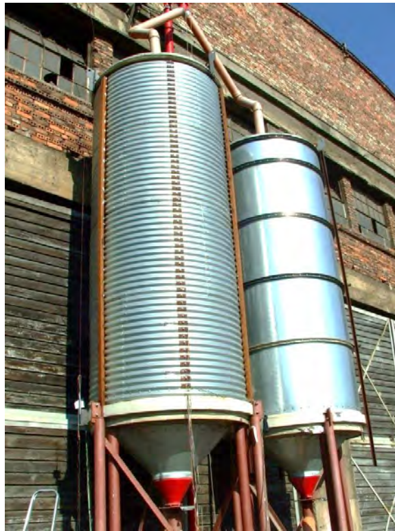
Rys. 5.13. Stanowisko badawcze Pawłowskiego – silos lejowy z płaszczem z blachy falistej [65]
