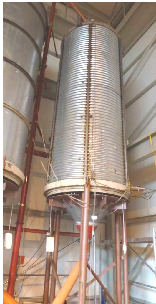
Rys. 4.5. Widok stanowiska badawczego: a) nieuzębrowany silos z blachy falistej, b) w pełni uzębrowany silos z blachy falistej (6 żeber C80 na obwodzie)
