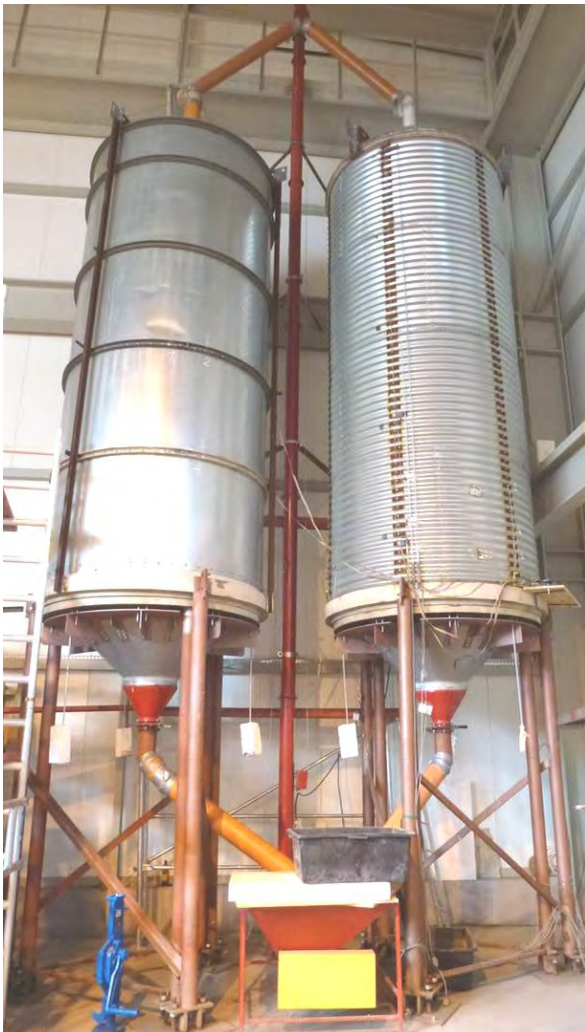
Rys. 4.5. Widok stanowiska badawczego: a) nieuzębrowany silos z blachy falistej, b) w pełni uzębrowany silos z blachy falistej (6 żeber C80 na obwodzie)
