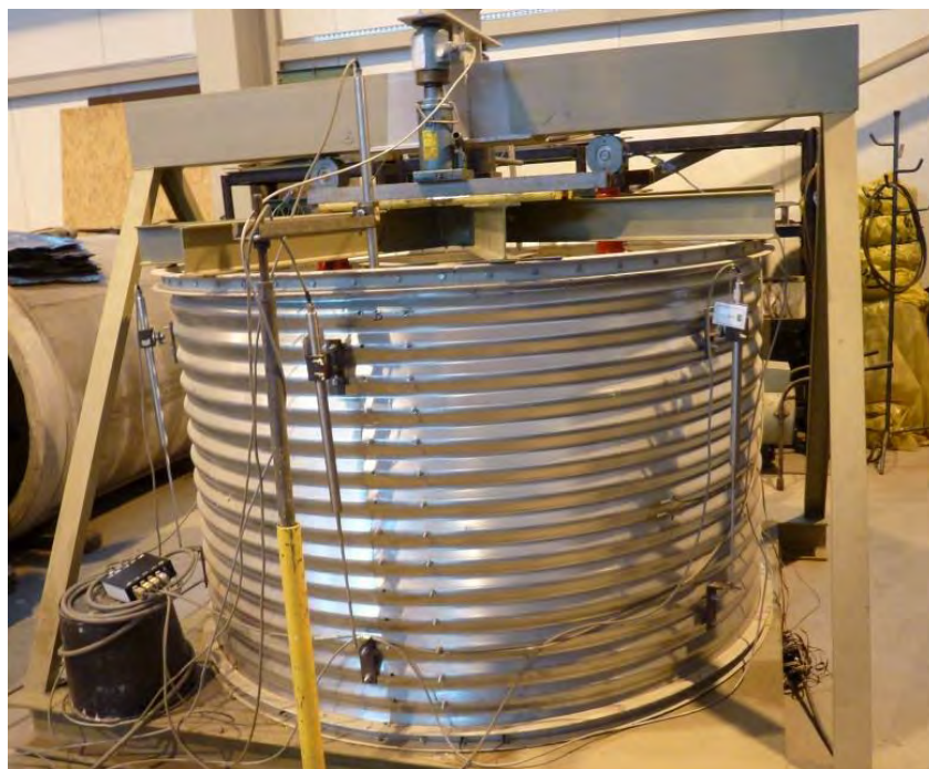
Rys. 4.3. Model jednostkowego fragmentu nieuzębrowanego płaszcza silosu o wysokości h_{p2} = 1180 mm i średnicy d_{c2} = 1800 mm z zainstalowaną aparaturą pomiarową
