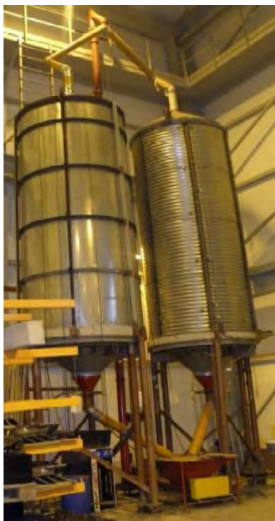
Rys. 2.27. Widok stanowiska badawczego silosu z blachy falistej Aniszczuk [1]
