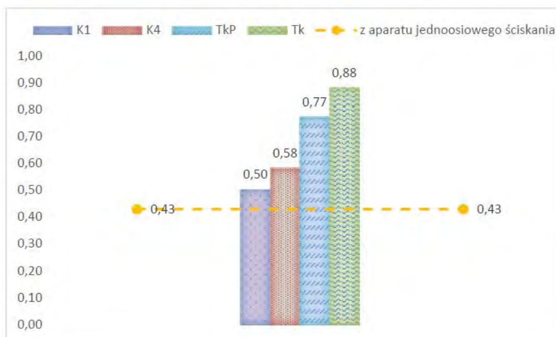
Rys. 2.37. Wpływ południkowej podatności walcowego płaszcza silosu na wartość ilorazu parcia bocznego K granulatu HDPE [1]
