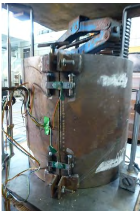
Rys. 4.4. Aparat badawczy do wyznaczania właściwości ośrodków sypkich
