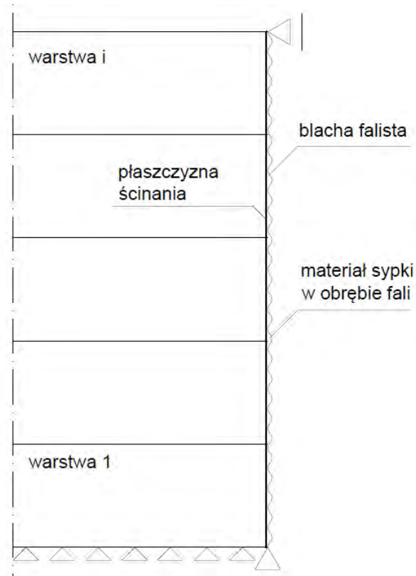
Rys. 5.1. Osiwosymetryczny model numeryczny nieuzębrowanego silosu wypełnionego ośrodkiem sypkim
