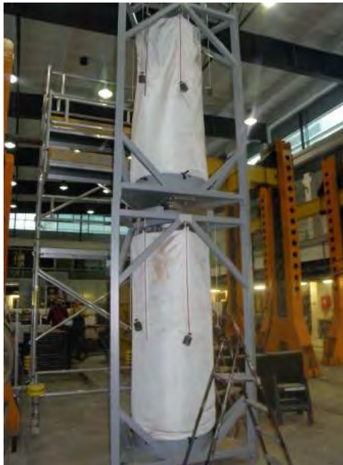
Rys. 2.31. Stanowisko badawcze silosu o wiotkim płaszczu z tkaniny poliamidowej o średnicy d_c = 0,8 m [1]
