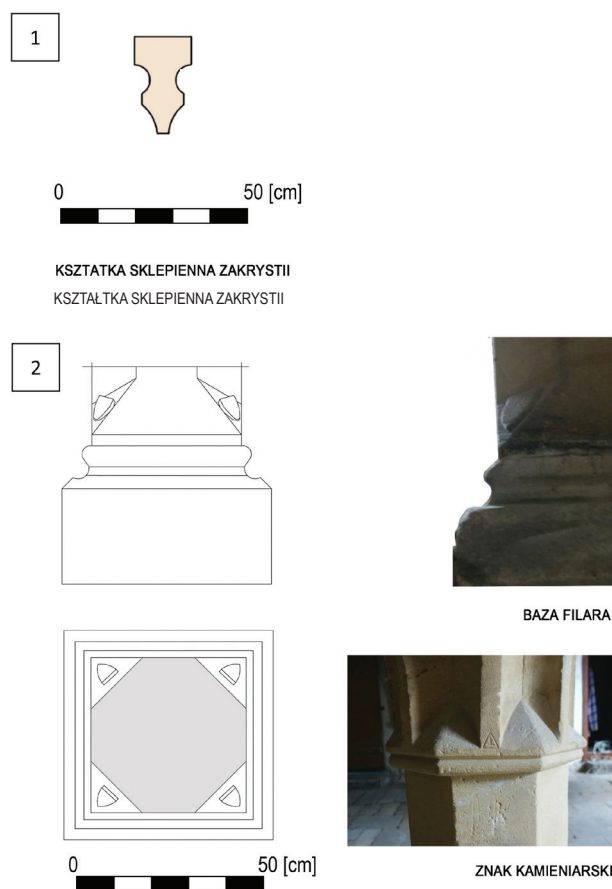
Il. 6. Dokumentacja pomiarowa wybranych detali architektonicznych: 1 – kształtka żebrowa sklepienia, 2 – baza filara (oprac. L. Smirnowa)
