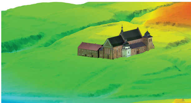
Il. 2. Topografia wschodniego stoku Wzgórze Świętojakubskie w Sandomierzu (pomiar Lidar) z wpisaniem modelem przestrzennym współczesnej bryły kościoła św. Jakuba i pozostałości klasztoru dominikanów (oprac. A. Gołembnik, I. Żyła)
