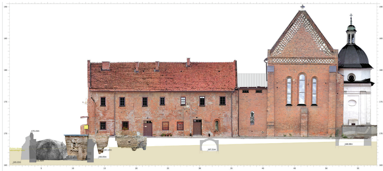
Il. 3. Sandomierz, kościół św. Jakuba i klasztor dominikanów. Rzut ortogonalny wschodniej elewacji założenia, wygenerowany ze spójcjonowanej chmury punktów skaningu laserowego 3D, wraz z odkrytymi podczas badań archeologicznych relikdami dawnej zabudowy i poziomem stropu warstw naturalnych (oprac. A. Gołębniak, I. Żyła)
