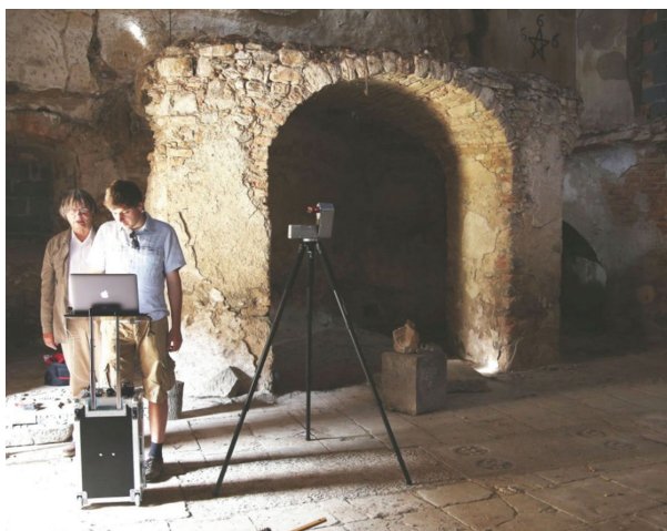
Il. 5. Wnętrze kościoła, rozstawione stanowisko pracy z tachimetrem laserowym (fot. I. Krawiec, sierpień 2018)
