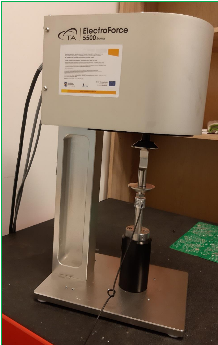
Rys. 58. Maszyna wytrzymałościowa ElectroForce 5500 z zamontowaną próbką
