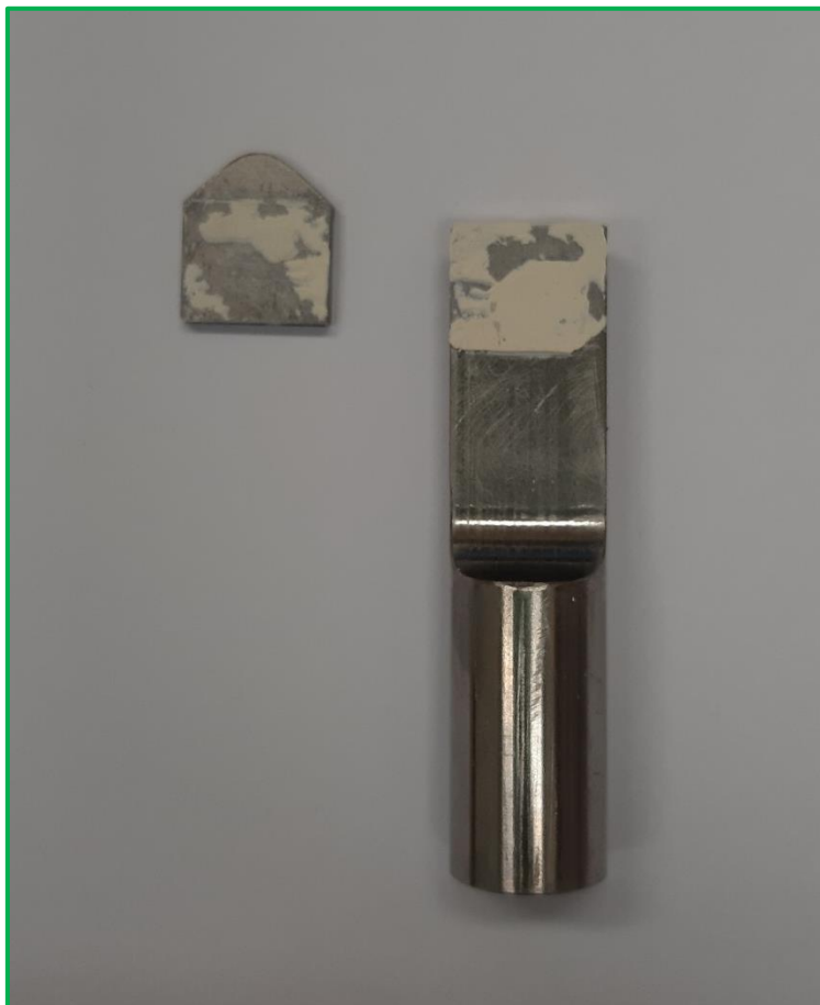
Rys. 63. Wygląd połączenia klejonego po zniszczeniu
