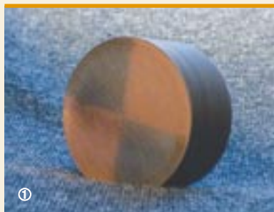
MPP: walec zbudowany z kompozycji dwóch materiałów: stali i miedzi
