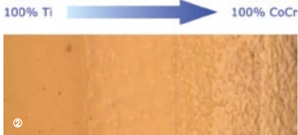
Przekrój przez obiekt wytworzony ze zmiennej, płynnie regulowanej mieszanki tytanu i stopu CoCr
