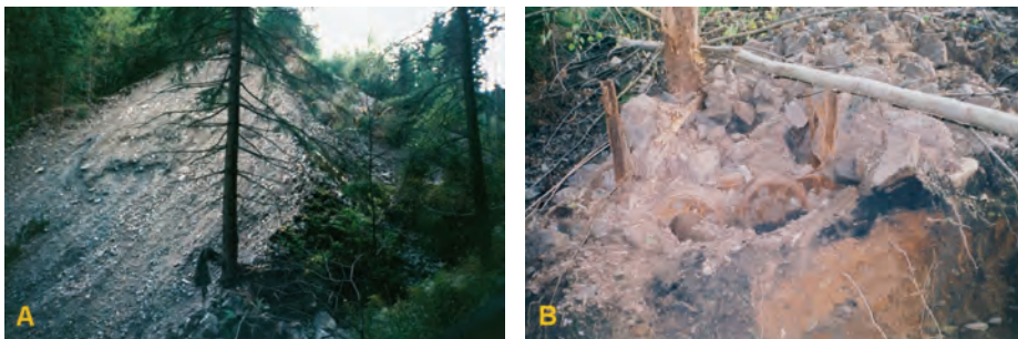
Ryc. 25. Sztolnia nr 17: A – hałda, B – wózek górniczy wymyty ze zbocza hałdy podczas powodzi w lipcu 1997 r. (stan z 25.09.1997 r., fot. R. Borzęcki)
