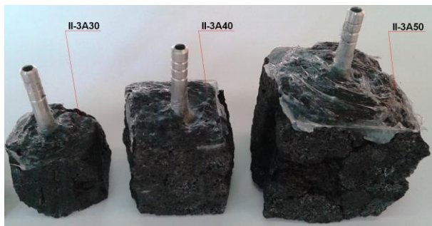
Rys. 4.9. Próbkki koksu o kształcie bryły sześcienniej: A30 (30×30×30 mm), A40 (40×40×40 mm), A50 (50×50×50 mm)
