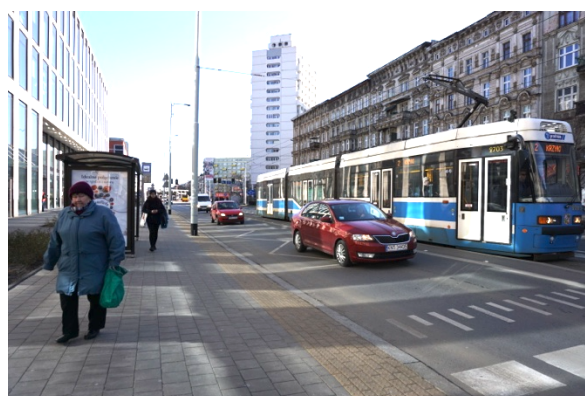
Rys. 50. Przystanek tramwajowy wiedeński, dzięki miejscowemu podwyższeniu jezdni wsiadanie/wysiadanie do tramwaju staje się łatwiejsze, przystanek z zadaszoną wiat, Curie-Skłodowskiej, Wrocław (zdj. autor)
