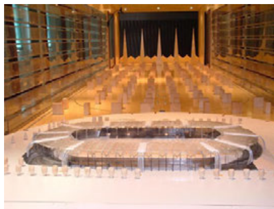
Rys.7.37. Model (1:200) stadionu w Poznaniu umieszczony w przestrzeni pomiarowej tunelu aerodynamicznego; przekrycie stadionu w Tarnowie w przestrzeni pomiarowej tunelu aerodynamicznego, Laboratorium Inżynierii Wiatrowej, [330].
