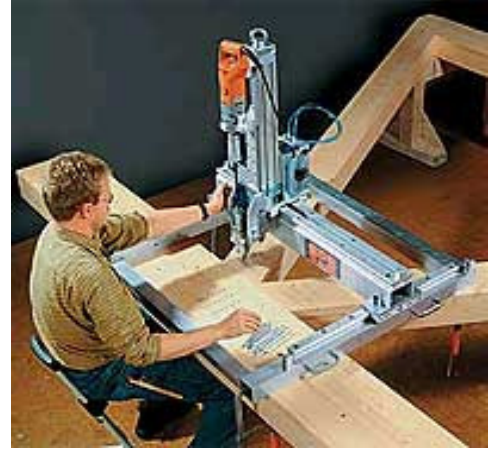
Rys. 5.6. Dźwigary nośne konstrukcji Expodachu w Hanowerze podczas obróbki za pomocą zestawu sterowanego numerycznie CNC w zakładzie produkcyjnym, [335].
