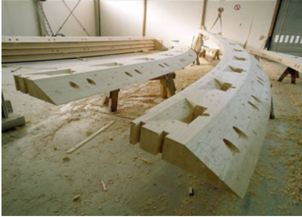
Rys. 5.6. Dźwigary nośne konstrukcji Expodachu w Hanowerze podczas obróbki za pomocą zestawu sterowanego numerycznie CNC w zakładzie produkcyjnym, [335].
