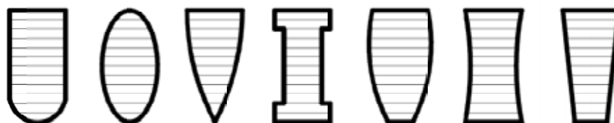
Rys.1.3. Przykładowe przekroje słupów i belek o dowolnych kształtach wytwarzane przy użyciu zestawu sterowanego numerycznie, CNC, [343], [335], [329], [327], [314], [308].
