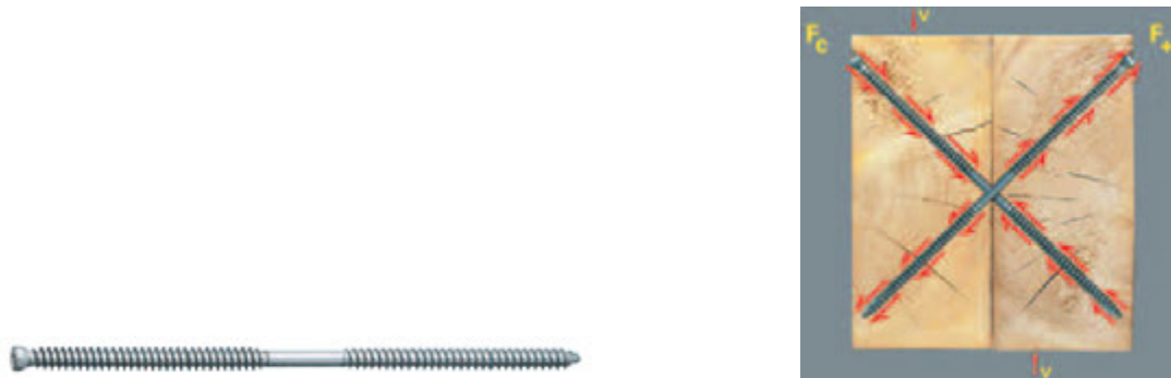
Rys.7. 31. Samonawiercący wkręt łącznikowy. Schemat połączenia wkrętami łącznikowymi, [340].
