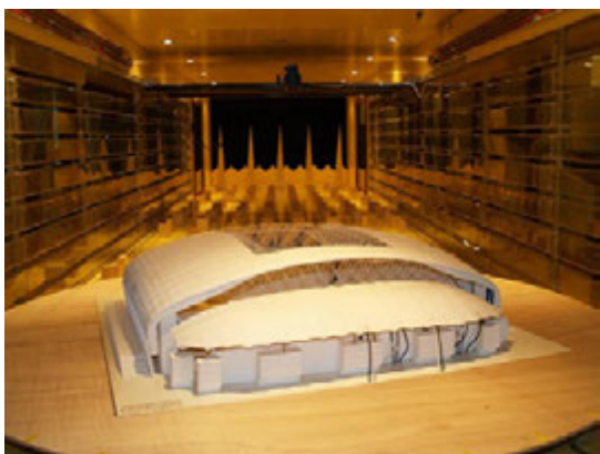
Rys.7.37. Model (1:200) stadionu w Poznaniu umieszczony w przestrzeni pomiarowej tunelu aerodynamicznego; przekrycie stadionu w Tarnowie w przestrzeni pomiarowej tunelu aerodynamicznego, Laboratorium Inżynierii Wiatrowej, [330].
