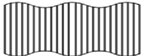
Rys. 5.146. Pawilon Japoński na światową wystawę Expo w Hanowerze 2000 r. Architektura: Shigeru Ban konsultacja: Frei Otto Konstrukcja: Buro Happold Consulting Engineers, Frei Otto, Warmbronn, Stefan Polonyi, Köln – konsultacje. Schemat konstrukcji rzutu, [313], [357].
