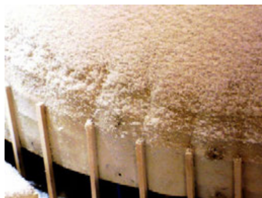
Rys.7.38. Model (1:200) stadionu w Poznaniu umieszczony w przestrzeni pomiarowej tunelu aerodynamicznego pokazujący rozkład pokrywy śnieżnej (symulacja obciążenia śniegiem), [330].
