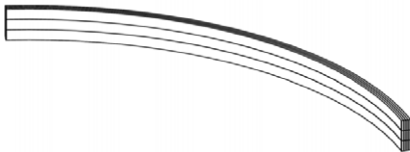
Rys. 5.13. Konstruowanie belek o wygięciu w płaszczyźnie poziomej, [357].
